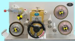
『ラボ・オプション』 素材の巻き取り・巻き出しにより 張力をかけた切断評価が可能
